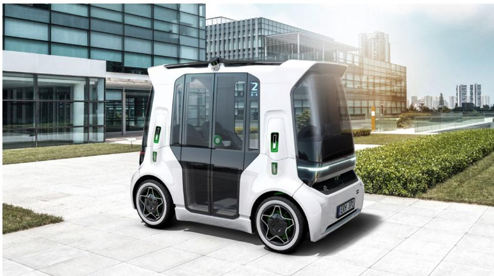
Ein weiteres Highlight sind die Schaeffler Intelligent Corner Modules: In den vier Radmodulen sind alle Antriebs- und Fahrwerkskomponenten einschließlich des elektrischen Radnabenmotors platzsparend in einer Einheit zusammengefasst.
